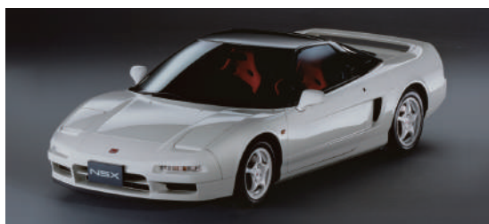
平成4年新增車款的NSX-R。車重僅為1230公斤，相較於傳統的5速手排車輛，實現了100公斤以上的輕量化。
