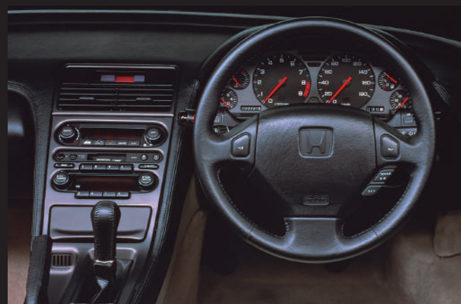
儀錶板採用六眼電氣式類比儀錶，以優化視野。每個按鈕都只具有一個功能，並以衛星狀排列。
