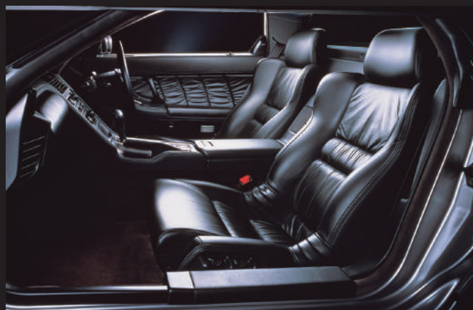
採用了頭枕與座椅一體的桶形座椅。標配電動座椅，適用於駕駛座和副駕駛座位。
