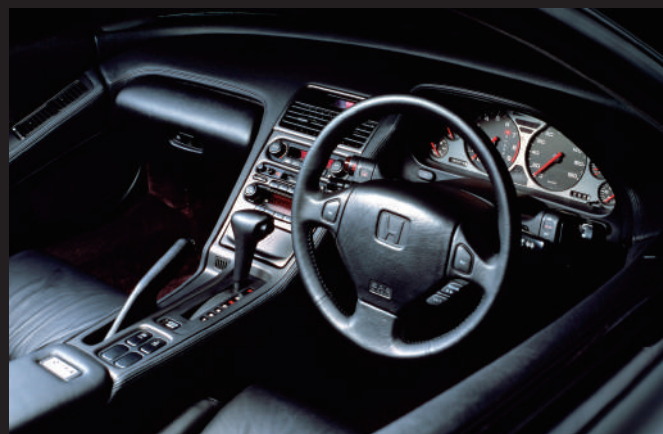
基於駕駛座和副駕駛座不同功能的需求，在此概念設計下，以大型中控台將駕駛座和副駕駛座分開。
