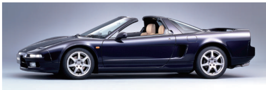
平成7年推出的T型車。它的特色在於可將車頂拆下後收納在後頂篷的設計。
